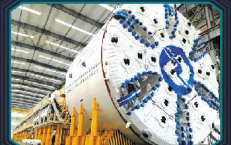
1月18日，海宏盾构机在大连始发，它堪称中国研发的最聪明的盾构机，也是世界上现有功能最全的盾构机，核心部件设计全球领先。海宏盾构机可以在12.26米直径的较小刀盘上实现常压换刀，创造了世界之最。它的应用，意味着跨海隧道工程领域，中国又掌握了一项绝技，给海底长大隧道施工开辟了新天地。
